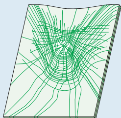
I lamineret sikkerhedsglas hæfter glassplinterne fast i plastfolien og minimerer risikoen for skæreskader.
